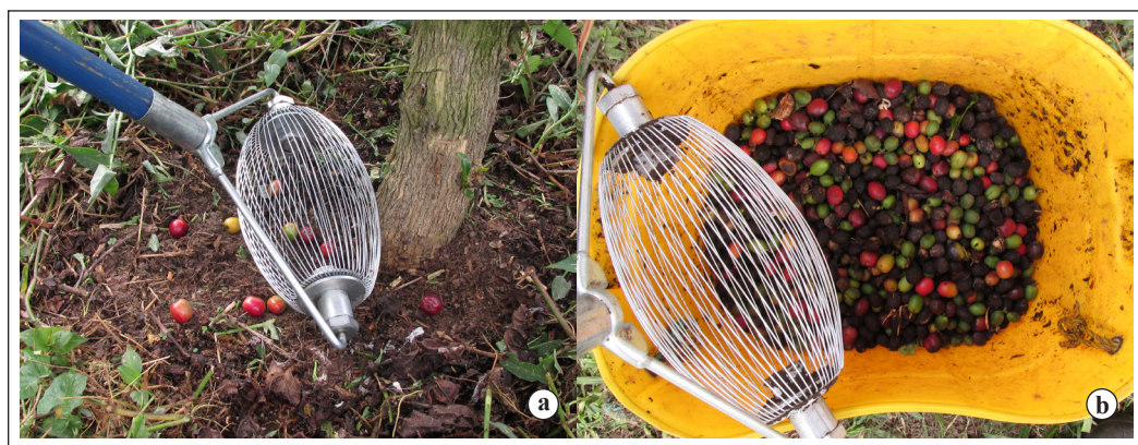
Figura 2. Dispositivo evaluado para recoger frutos de café caídos al suelo. a. Accionamiento en el plato del árbol; b. Descarga de frutos de café recogidos.
